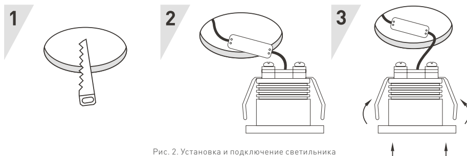
Рис. 2. Установка и подключение светильника
