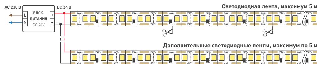
Схема 1. Подключение нескольких светодиодных лент с одной стороны
